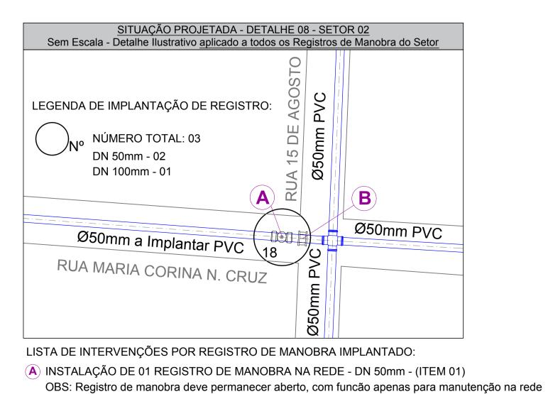
(B) IMPLANTAÇÃO DE 01 JUNTA GIBAULT DN 50mm - (ITEM 02)
