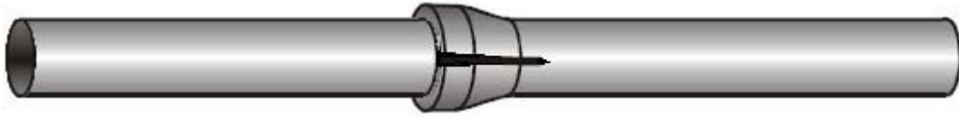
Figura 101 – Fissura na bolsa
